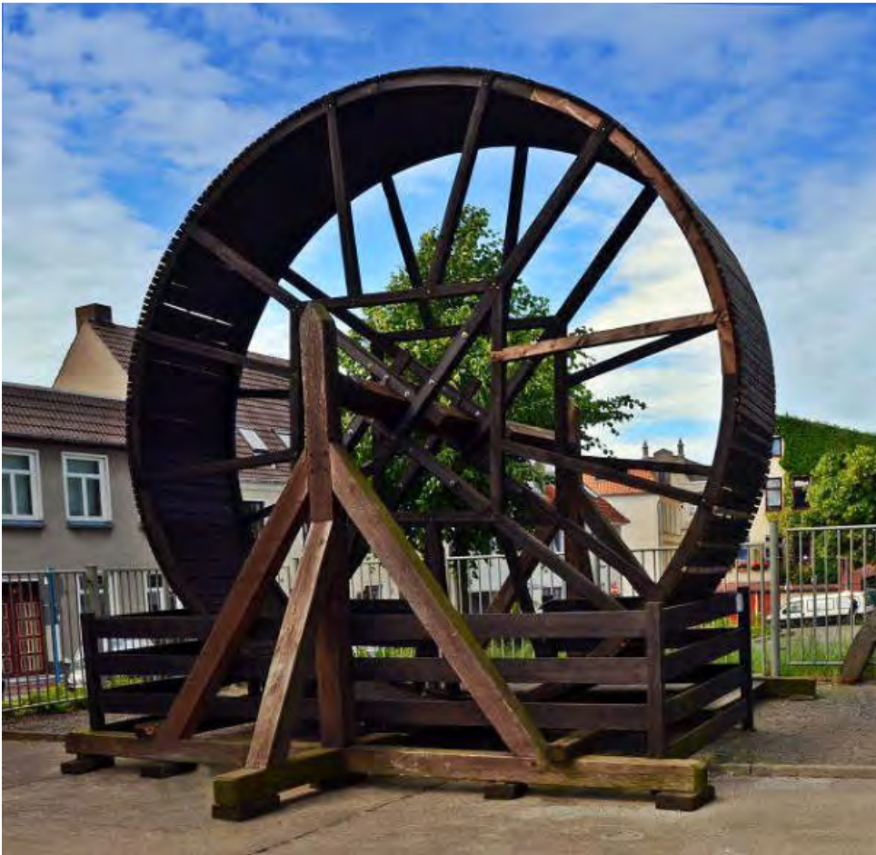
Nachbau einer mittelalterlichen Tretmühle zum Hochziehen von Lasten, Wismar
